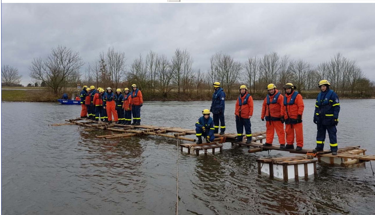
Schwimmsteg aus verschiedenen Elementen und Belastungsprobe
