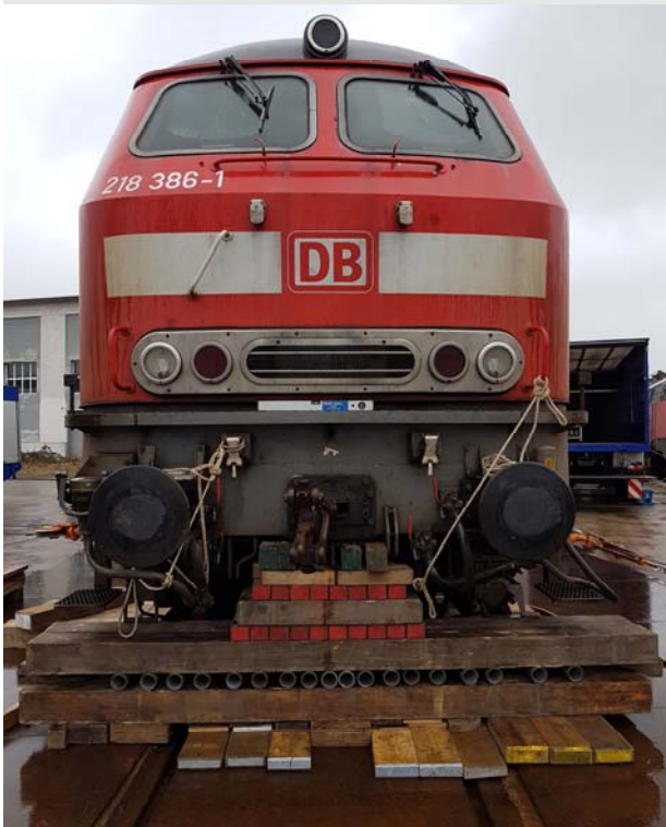
Oben: Das Gewicht der Lok liegt auf der Rollenbahn und sie kann jetzt verschoben werden.
