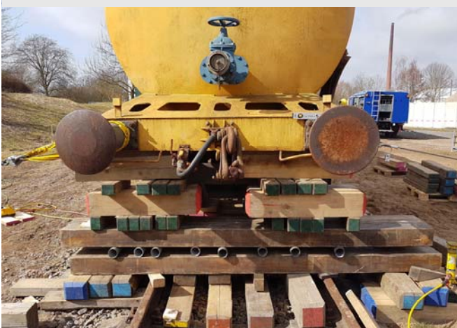
Oben: Kesselwagen wird verschoben & aufgleist
